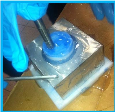
Après plusieurs tests sur les pneus des roues arrières, nous nous sommes fixé l'objectif de réaliser des pneus en silicone par injection sous étuvage. Nous avons donc demandé à notre centre de ressources de procéder à cette fabrication. Un mélange de silicone et de catalyseur est injecté autour de la jante, le tout dans un four, favorisant ainsi la polymérisation.
